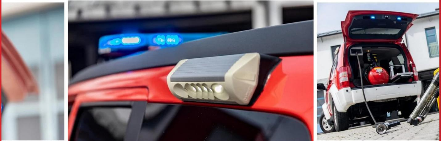
Mit einer integrierten Poly-Löschanlage mit einem Fassungsvermögen von 100 Litern ist es ideal, um Klein- und Entstehungsbrände, beispielsweise bei KFZ-Bränden, schnell unter Kontrolle zu bringen.
